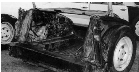
Dit restant van een DS kwam gewoon rijdend binnen. De auto was zelfs, volgens zeggen, "getectyleerd" geweest. Na een lange reeks schokkende ontdekkingen stelde de eigenaar de stoffelijke resten van zijn voiture ter beschikking aan de antiroest wetenschap.
